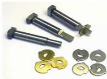
Върубные пуансоны с износостойким покрытием (повышение стойкости в 1,4...1,6 раза)
