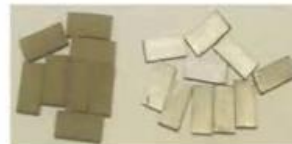
Върубные пуансоны с износостойким покрытием (повышение стойкости в 1,4...1,6 раза)
